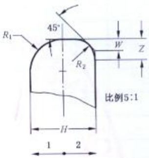
圆柱式触点的外形 (仅指柱塞式)
